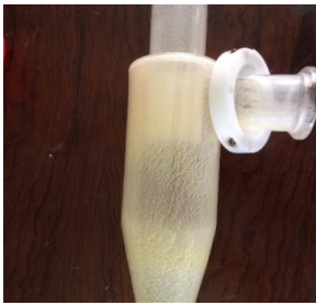
Hình 1. Sự bám dính, không tạo hạt ổn định của bột xoài trong bộ phận thu hồi (sấy mẫu 15°brix)
